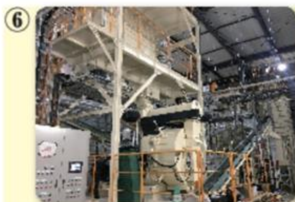
ペレットミル (CPM 社製 型式：7932-5 型) 能力：4トン/時間 粉砕後の原料をペレットに成形する機械
