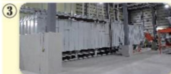
ムービングフロア (Rudnick&Enners 社製) 能力：貯蔵量 200m³ 破砕されたチップを床を稼働させることで搬送する機械
