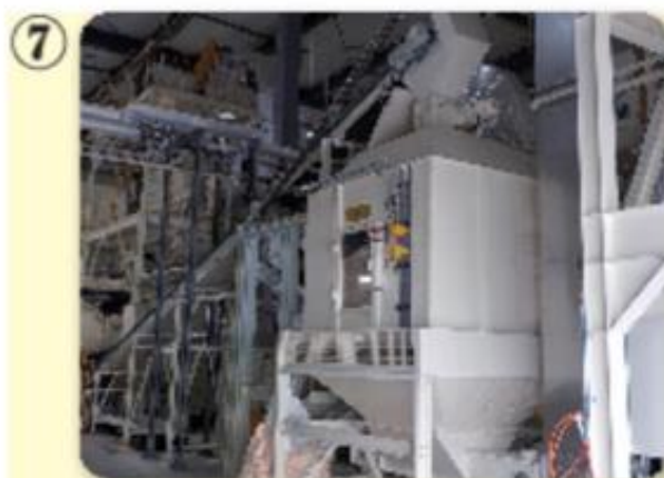
クーラー (Geelen 社製) 能力：4トン/時間 成形されたばかりの高温のペレットを 外気で冷やす機械
