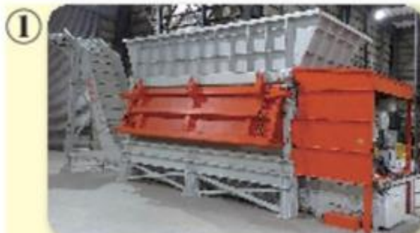
デバーカー (Rudnick&Enners 社製) 能力：8トン/時間 丸太のバークを剥ぐ機械
