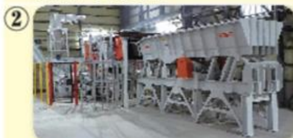
ツインチップパー (Rudnick&Enners 社製) 能力：8トン/時間 丸太をチップ状に破砕する機械
